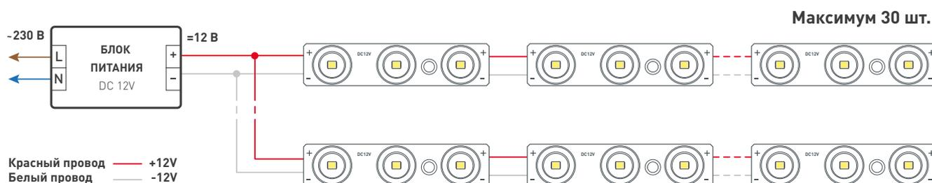
Схема 1. Подключение модулей.
