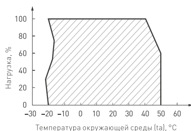
Рис. 2. Максимальная допустимая нагрузка, % от мощности источника
