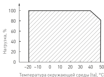
Рис. 3. Максимальная допустимая нагрузка, % от мощности источника
