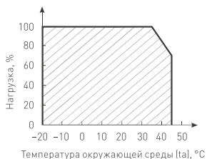
Рис. 2. Максимальная допустимая нагрузка, % от мощности источника
