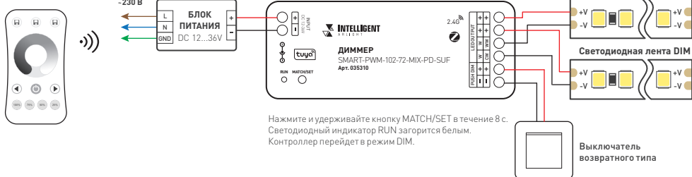
Рис. 1. Схемы подключения диммера SMART-PWM-102-72-MIX-PD-SUF
