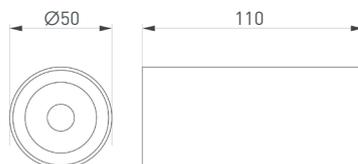
Накладной светильник, черный алюминиевый корпус. Цвет свечения БЕЛЫЙ ДНЕВНОЙ 4000 К, св. поток 650 лм, CRI(Ra)>90, угол излучения 36°. IP40. Питание AC 220–240 В, мощность 9 Вт, встроенный драйвер. Размеры: Ø50×110 мм.
