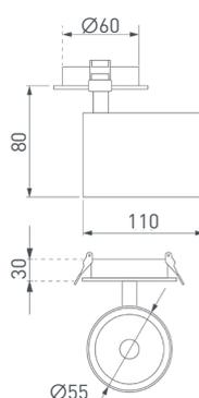
Встраиваемый поворотный светильник, черный алюминиевый корпус. Цвет свечения БЕЛЫЙ ДНЕВНОЙ 4000 К, св. поток 666 лм, CRI(Ra)>90, угол излучения 25°. IP20. Питание AC 230 В, мощность 9 Вт. Размеры: Ø55×110×80 мм.
