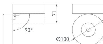
Накладной поворотный светильник, черный алюминиевый корпус. Цвет свечения БЕЛЫЙ ДНЕВНОЙ 4000 К, св. поток 800 лм, CRI(Ra)>90, угол излучения 24°. Поворачивается вокруг своей оси на 350° и отклоняется на 90°. IP40. Питание AC 220–240 В, мощность 12 Вт, встроенный драйвер. Размеры: Ø100×71 мм.
